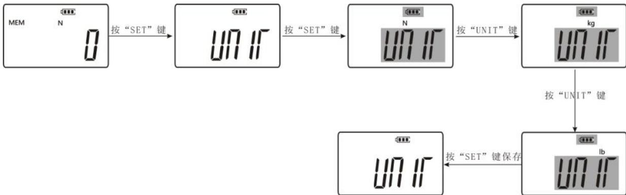
3.2.3 峰值设置：上步操作完成后，按“MEMO”键选择“PEAK”，进入后按“MEMO”在“PEAK”（峰值模式）、无此字符显示（表示实时荷重值模式）二种模式之间相互切换，选择所需模式，再按“SET”键保存并进入下一功能设置，如下图所示：
