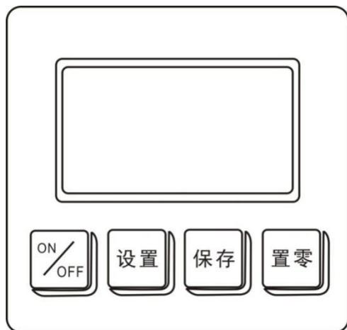
2.3.1 ON/OFF: 开关机键, 按此键时, 电源打开或关闭。
