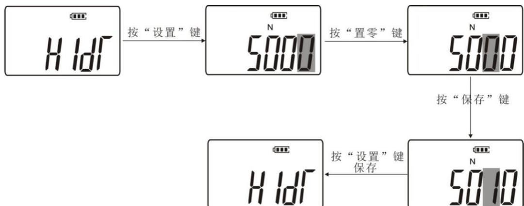
3.2.4  $LodT$  (LODT) 下限值设置：按“设置”键进入下限值设置，同上限值设置的操作，分别按“保存”、“置零”键，进行数字调整，选择所需数值，再按“设置”键进入下一功能设置。
