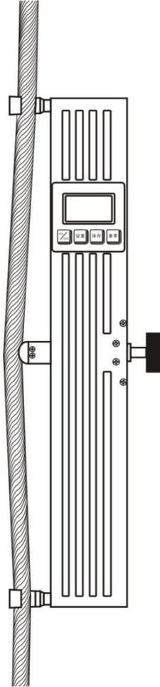
4.4 测试完成后，将调整螺钉拧松，将被测绳索卸下。
