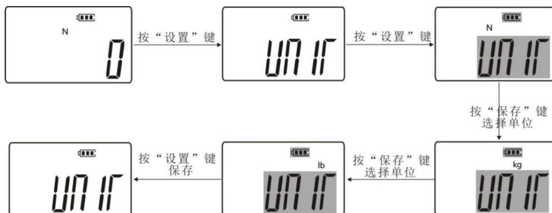
3.2.2 **PEAK** (PEAK) 峰值设置：上步操作完成后，按“保存”键选择“PEAK”，再按“设置”键进入峰值设置后按“保存”在“PEAK”（峰值模式）、无此字符显示（表示实时荷重值模式）二种模式之间相互切换，选择所需模式，再按“设置”键保存并返回到设置界面，如下图所示：
