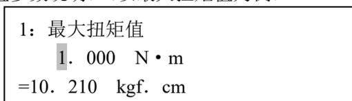
通过向上键和向下键进行移位和数据修改，此时按设置键，确定并保存设置数据，（如按置零键返回，不修改数据）。设置的数据不能超过最大负荷值。
