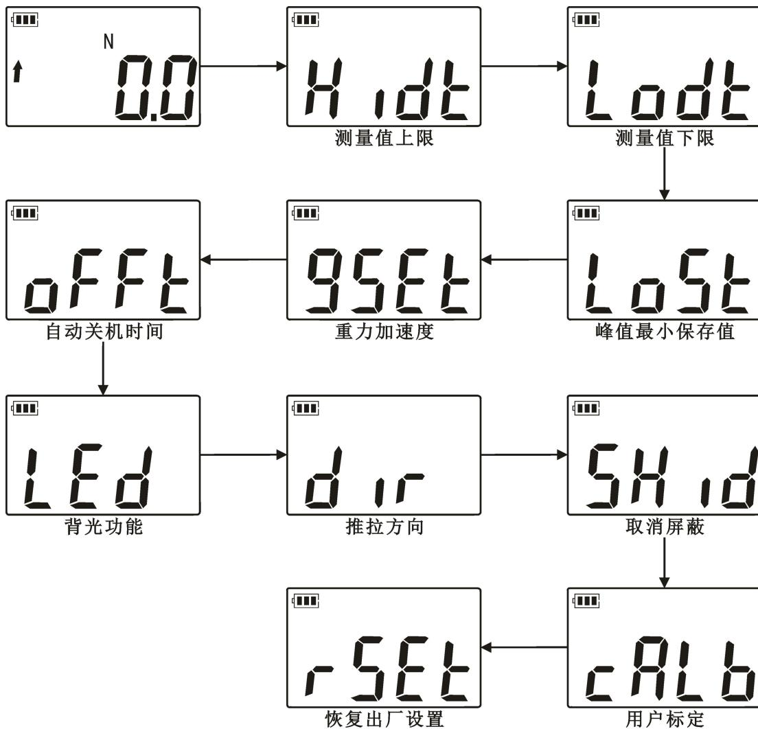
7.1 测量值上限：设定测量值上限，上限值默认为满量程，测量值高于上限为超出范围，屏幕显示“MAX”并蜂鸣器报警长鸣，用户可自由设定上限值。如下图所示：
