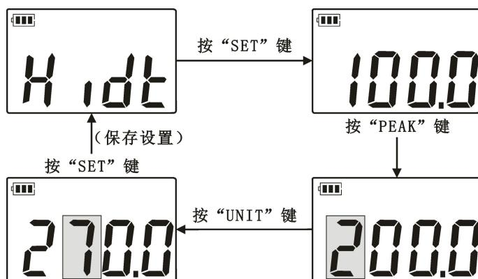
7.2 测量值下限：设定测量值下限，下限值默认为0，测量值低于下限为超出范围，屏幕显示“MIN”并蜂鸣器报警长鸣。用户可自由设定下限值，选择该项菜单设定数值，操作步骤同上限值一样。
